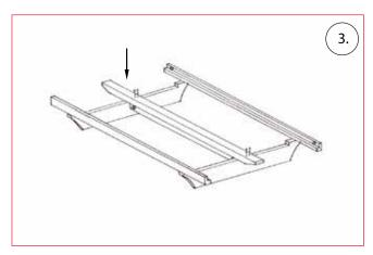
Placer la latte de support au centre des pieds de lit et la fixer aux pieds à l'aide des 4 vis  $6\times80$  mm fournies, comme décrit au point 5. Avec la largeur de 140 mm, la latte de support est supprimée.
