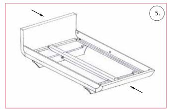
Fixer la tête de lit et le pied de lit aux côtés cornière et aux éléments latéraux. Serrer fermement le raccord au centre de l'élément latéral. Visser maintenant les vis de la latte de support sur les pieds de lit.
