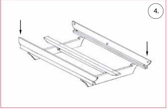
Insérer les éléments latéraux avec la languette dans la rainure des côtés cornière et prévisser légèrement le raccord central.
