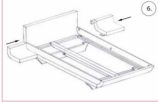
Fixer la console à gauche et à droite dans l'évidement fraisé à l'arrière de la tête de lit et sur la face inférieure des côtés cornière avec chaque fois 2 vis de 4 × 35 mm.
