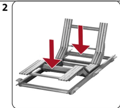
**Lorsque le levier est tiré,** appuyez sur la zone correspondante jusqu'à la position horizontale (le cas échéant, en exerçant plus de force)
