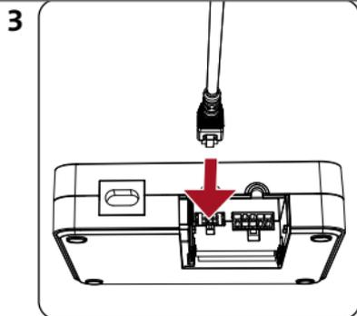
Raccordez le boîtier de contrôle à la station de base
