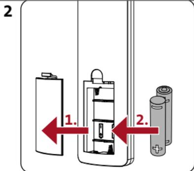
Placez deux nouvelles piles type AAA (n'utilisez pas des piles rechargeables) dans la télécommande radio, respectez la polarité!
