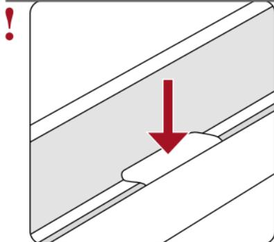
Tous les 6 points d'appui du support d'adaptation doivent reposer correctement (longerons latéraux/support de montage central)
