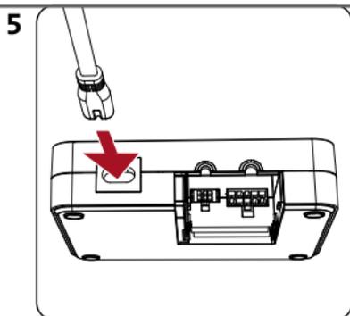
5 Connectez le câble électrique avec le boîtier de contrôle et branchez l'unité au réseau (la tension du réseau électrique et la tension d'entrée indiquée sur la plaque signalétique doivent être identiques!)
