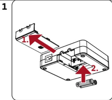
1 Placez deux nouvelles piles type AAA (n'utilisez pas des piles rechargeables) dans le boîtier de contrôle, respectez la polarité! Si le boîtier émet un bip, la tension de la pile est trop faible > remplacez les piles
