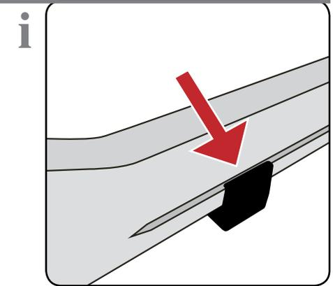
Les attaches du câble peuvent être encliquetées dans la partie inférieure, transversale et rainurée du support d'adaptation à côté du moteur
