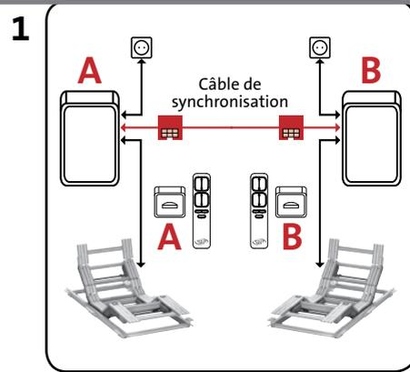
Débranchez les stations de base des boîtiers de commande, puis raccordez le câble de synchronisation aux deux boîtiers de commande
